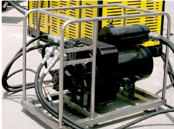
Fig. 10 Hydraulic compressor UNIAIR 5000/8
